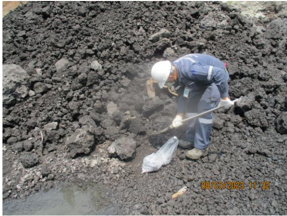
รูปที่ 4-59 เก็บตัวอย่างกากของเสียบริเวณที่กอง Slag จุดที่ 1 เก็บตัวอย่างในวันที่ 8 มีนาคม 2566
