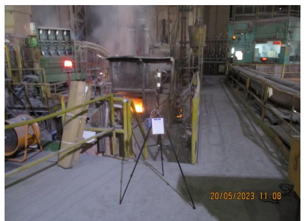
รูปที่ 4-76 ตรวจวัดคุณภาพอากาศบริเวณห่างจากเตาหลอม LF ประมาณ 10 เมตร เก็บตัวอย่างในวันที่ 20 พฤษภาคม 2566
