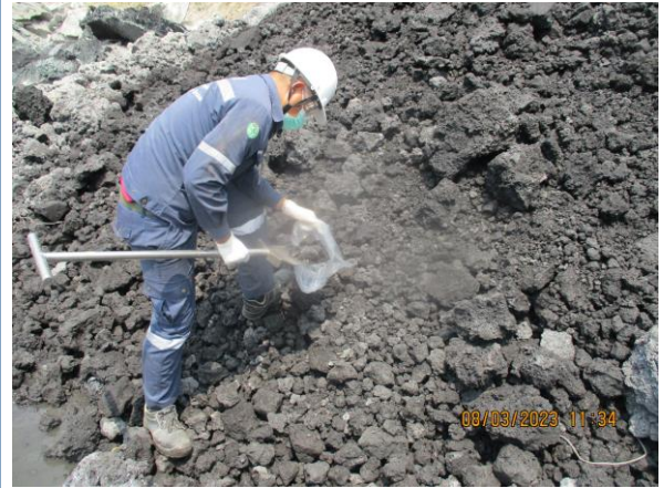
รูปที่ 4-60 เก็บตัวอย่างกากของเสียบริเวณที่กอง Slag จุดที่ 2 เก็บตัวอย่างในวันที่ 8 มีนาคม 2566
