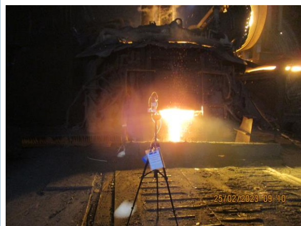
รูปที่ 4-69 ตรวจวัดคุณภาพอากาศบริเวณหน้าเตาหลอม EAF เก็บตัวอย่างในวันที่ 25 กุมภาพันธ์ 2566
