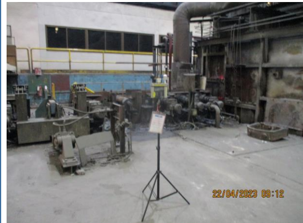
รูปที่ 4-68 ตรวจวัดระดับความร้อนบริเวณหน้าเตาอบเหล็กโรงรีด 2 ตรวจวัดในวันที่ 22 เมษายน 2566
