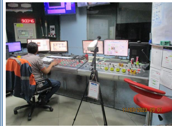
รูปที่ 4-62 ตรวจวัดระดับเสียงภายในห้องควบคุมของโรงหลอม ตรวจวัดในวันที่ 11 มีนาคม 2566
