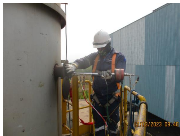
รูปที่ 4-52 ตรวจวัดคุณภาพจากปล่องระบายอากาศของโรงรีด 1 ตรวจวัดในวันที่ 12 มีนาคม 2566
