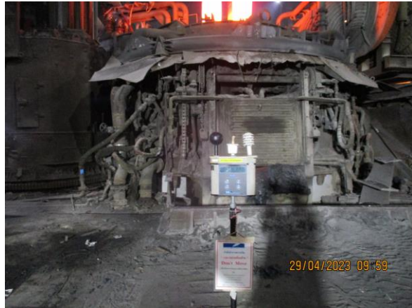
รูปที่ 4-65 ตรวจวัดระดับความร้อนบริเวณหน้าเตาหลอม EAF ตรวจวัดในวันที่ 29 เมษายน 2566
