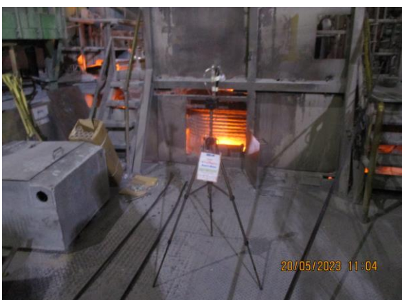
รูปที่ 4-75 ตรวจวัดคุณภาพอากาศบริเวณเตาหลอม LF เก็บตัวอย่างในวันที่ 20 พฤษภาคม 2566
