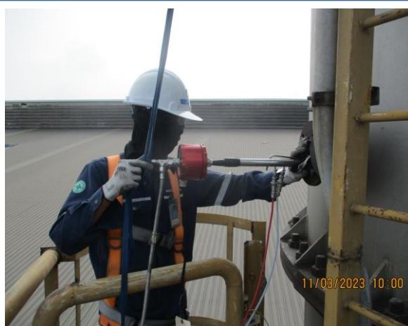
รูปที่ 4-53 ตรวจวัดคุณภาพจากปล่องระบายอากาศของโรงรีด 2 ตรวจวัดในวันที่ 11 มีนาคม 2566
