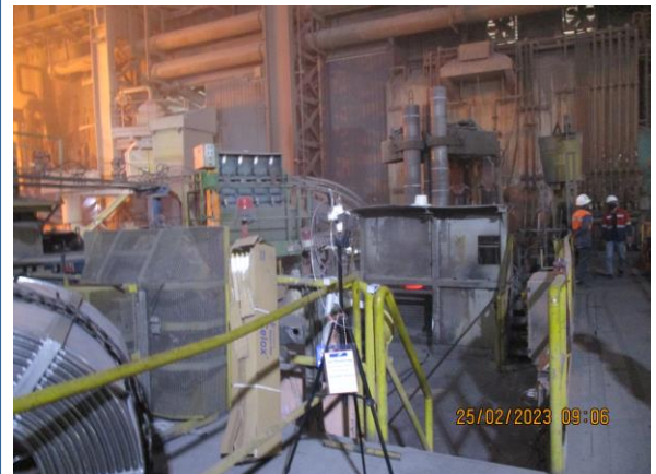
รูปที่ 4-72 ตรวจวัดคุณภาพอากาศบริเวณห่างจากเตาหลอม LF ประมาณ 10 เมตร เก็บตัวอย่างในวันที่ 25 กุมภาพันธ์ 2566
