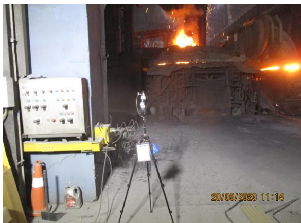
รูปที่ 4-73 ตรวจวัดคุณภาพอากาศบริเวณเตาหลอม EAF เก็บตัวอย่างในวันที่ 20 พฤษภาคม 2566
