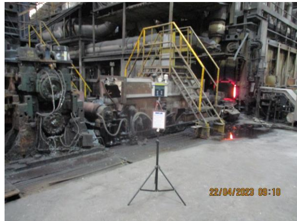
รูปที่ 4-67 ตรวจวัดระดับความร้อนบริเวณหน้าเตาอบเหล็กโรงรีด 1 ตรวจวัดในวันที่ 22 เมษายน 2566
