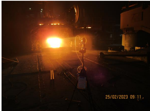
รูปที่ 4-71 ตรวจวัดคุณภาพอากาศบริเวณเตาหลอม LF เก็บตัวอย่างในวันที่ 25 กุมภาพันธ์ 2566
