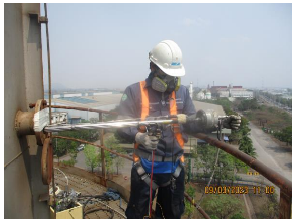
รูปที่ 4-51 ตรวจวัดคุณภาพจากปล่องระบายอากาศของโรงหลอม ตรวจวัดในวันที่ 9 มีนาคม 2566
