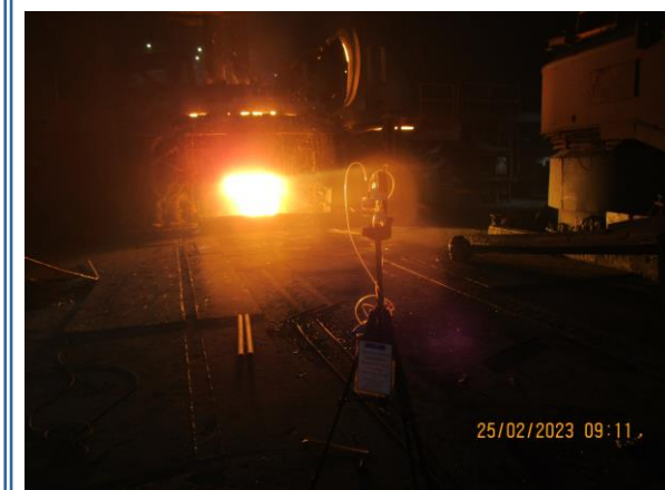
รูปที่ 4-70 ตรวจวัดคุณภาพอากาศบริเวณห่างจากเตาหลอม EAF ประมาณ 10 เมตร เก็บตัวอย่างในวันที่ 25 กุมภาพันธ์ 2566
